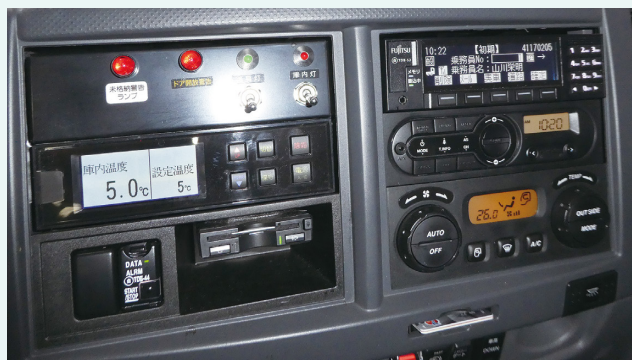
冷凍機のコントロールパネルとネットワーク型デジタコを連携
