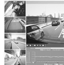
最大5台のカメラで同時撮影し、 ドライバーの「死角」低減を図った
