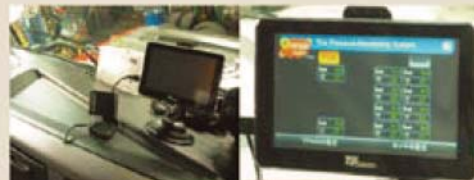
モニターをドライバーの見やすいところに取り付け、10輪同時表示、タイヤの空気圧と温度をそれぞれリアルタイム表示
